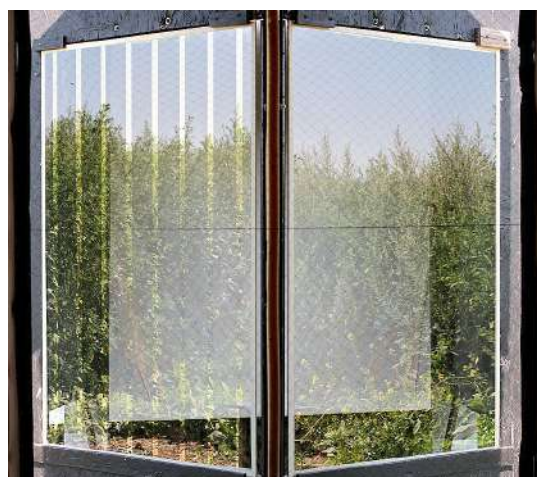
Un marquage en cours de développement (Fraunhofer ISE), avec des bandes transparentes, s’est révélé hautement efficace en position 1.
